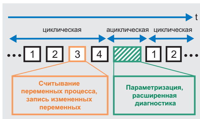
Детерминированная связь через шину PROFIBUS
