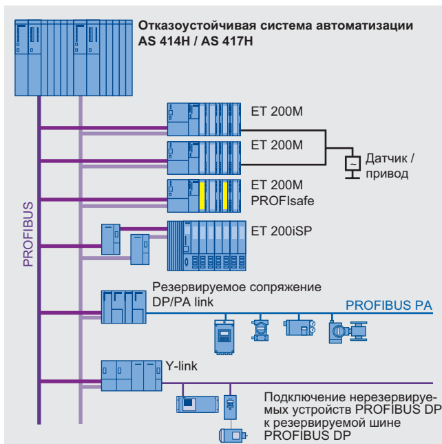
Схема PROFIBUS DP с резервированием
